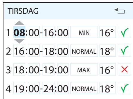
Hver dag kan programmeres med fire ulike tidsintervaller. Juster start- og stopptid for aktuelt intervall, og juster deretter ønsket hastighet og temperatur. For å aktivere intervallet, velg til slutt en grønn hake. Intervallet vil da være aktivt på valgte tidspunkt og ukedag. Et rødt kryss innebærer at intervallet ikke er aktivert. Ved behov, velg deretter ytterligere et intervall og gjenta prosedyren.
